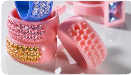
Figura 2. Molde en cera con gemas pre-engastadas
