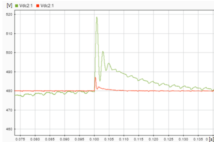
Figura 35. Tensión de salida con condensadores calculados (gráfica verde) y condensadores de mayor capacitancia (gráfica naranja).
