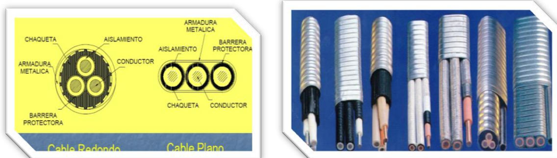
Figura 19. Tipos de Cables y Estructuras
