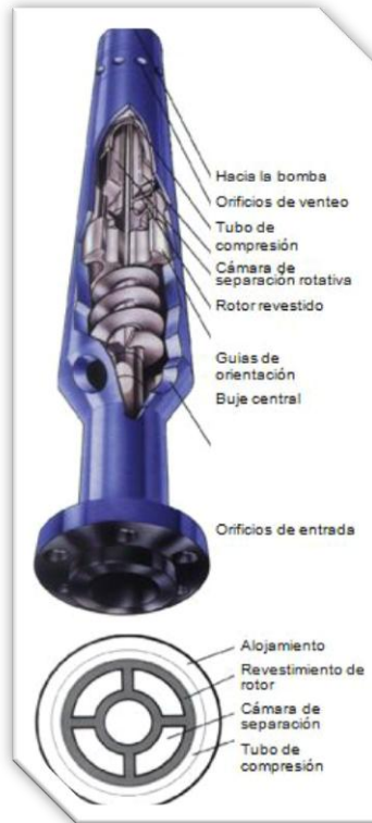
Figura 15. Separador de Gas Rotativo
