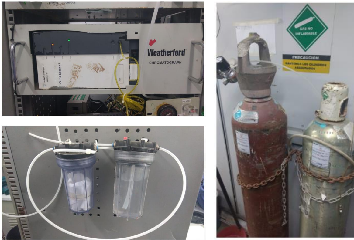
Figura 23. Cromatógrafo, sistema de filtro en la línea de gas y cilindro de helio que brinda arrastre al cromatógrafo.
