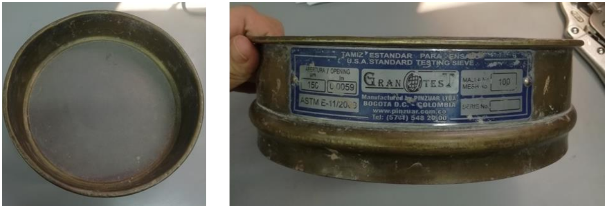
Figura 15. Fotografía de un tamiz para recolección de muestra, malla 150µm significa que permite el paso de partículas menores o iguales a 150 µm.
