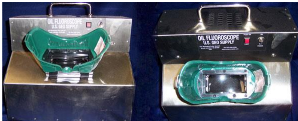
Figura 28. Fluoroscopio en donde se introducen las muestras para realizar fluorescencia al corte.
