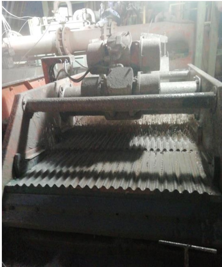
Figura 14. Fotografía de una Shale Shaker o Zaranda por donde salen los rips de perforación
