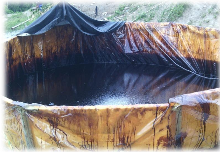
Fotografía 7. Tanque de recolección de hidrocarburo, Río Caunapí, Tumaco – Nariño.
