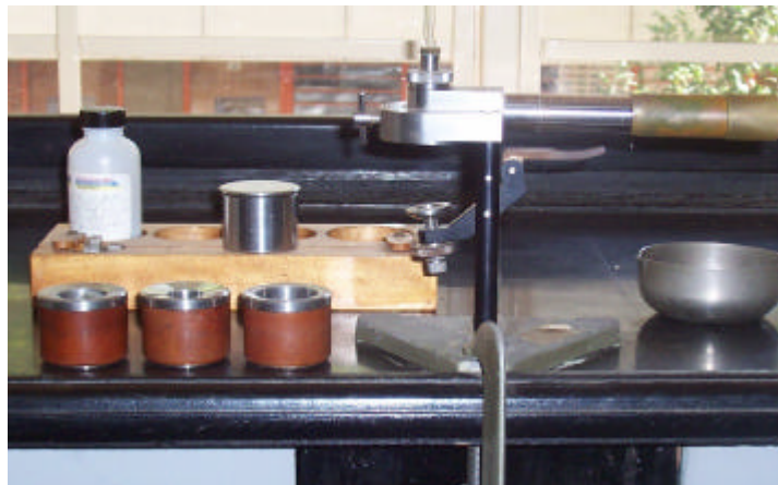
Figura 12. Porosímetro Ruska para medir la porosidad interconectada de los compactos porosos de titanio
