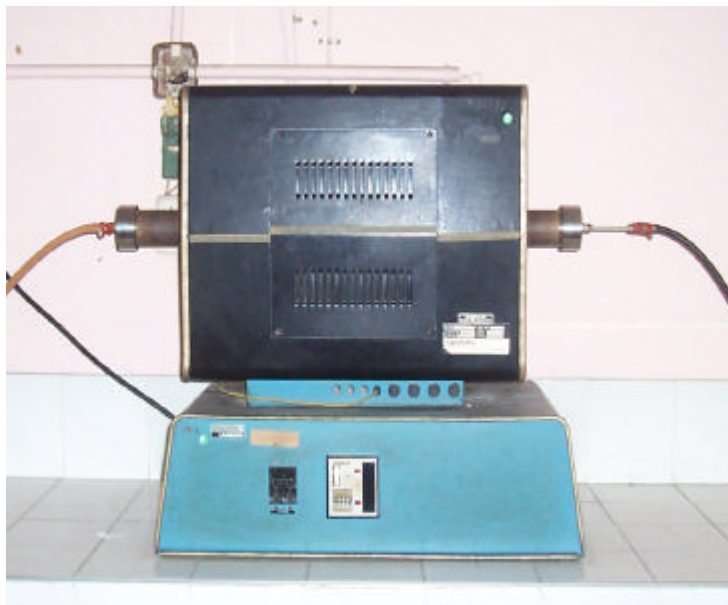
Figura 10. Horno empleado en la sinterización de las preformas de titanio
