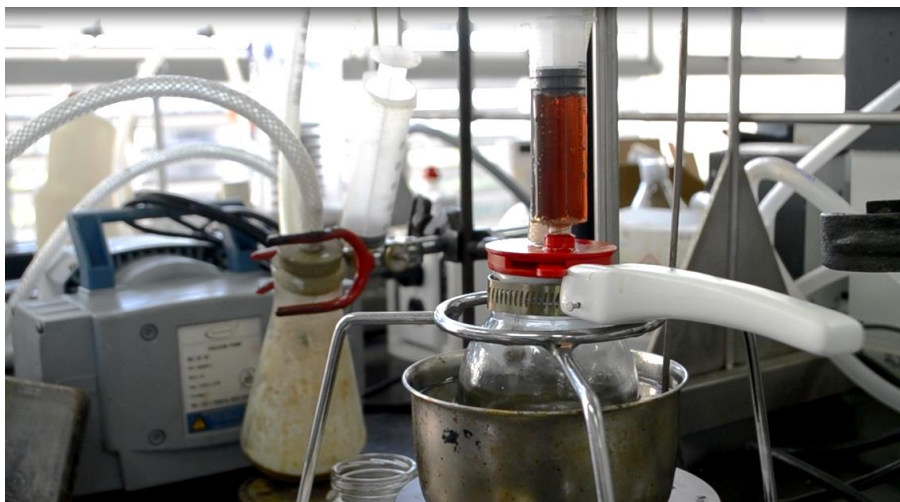
Figura 43. Inyección del MDI.
