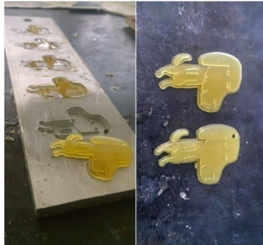
Figura 39. Desmoldeo de piezas.
