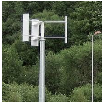
Figura 17. Turbina eólica de eje vertical de alabe recto.
