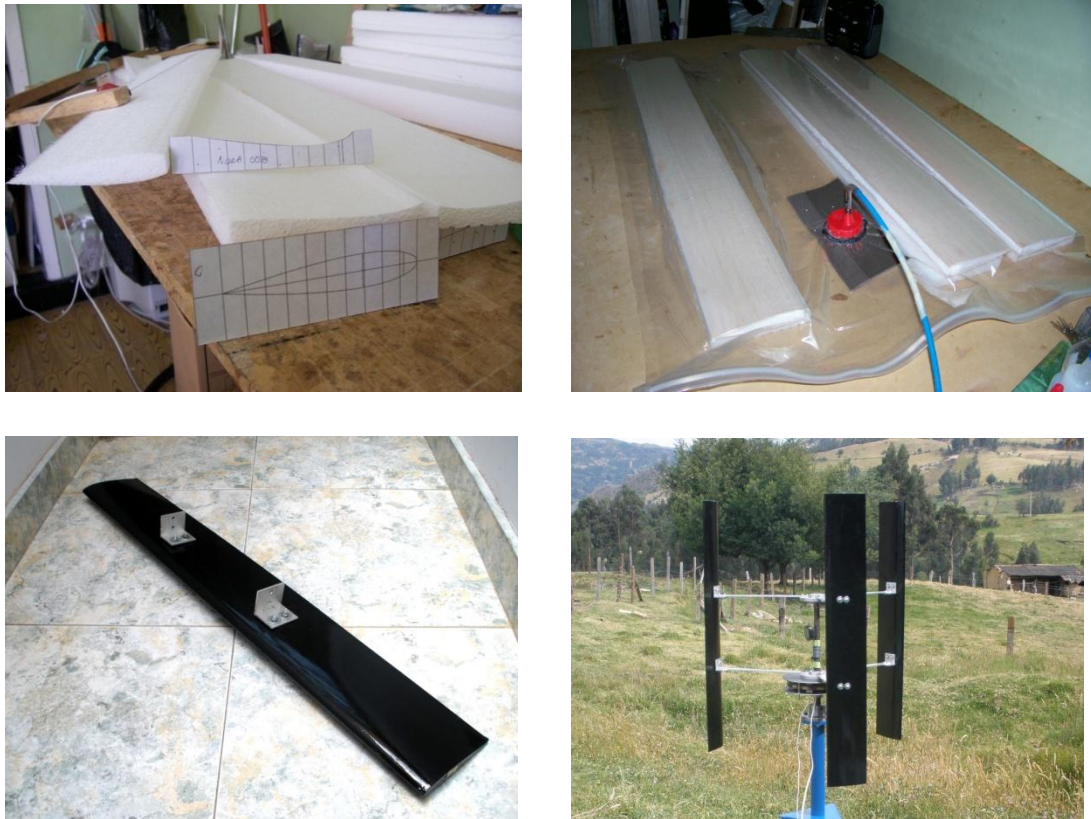
Figura 67. Etapas del proceso de fabricación de los álabes.
