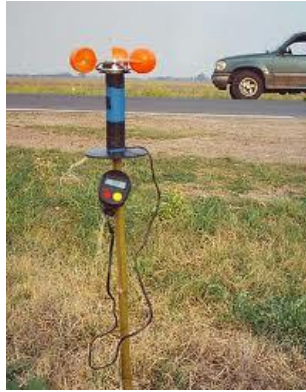
Figura 4. Medición en sitio de ubicación de la turbina.
