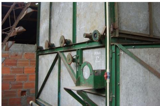
Foto 5. Sistema de transmisión. Sin cadena y sin motor. Fuente: autores
