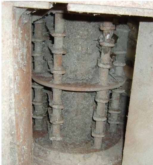
Foto 2. Martillos de la trituradora. Estado inicial. Fuente: Autores
