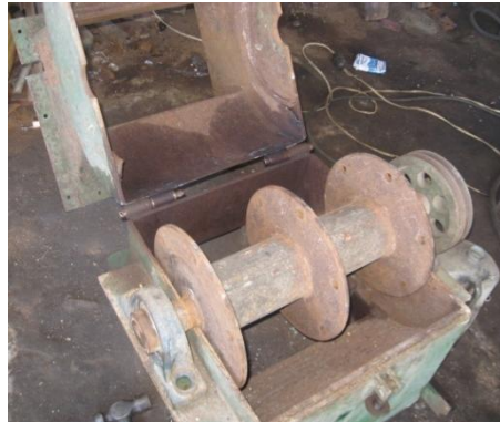
Foto 8. Muestra del proceso de mantenimiento del molino de martillos
