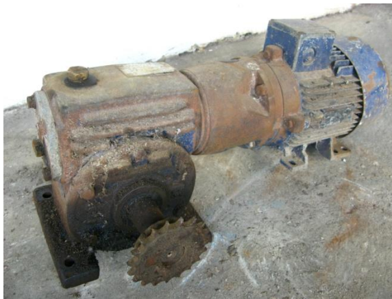
Foto 13. Motor-reductor sistema de transporte 2hp @ 90rpm.
