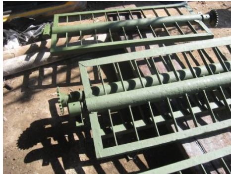
Foto 14. Paletas del Bio-reactor con capa de pintura anticorrosiva.
