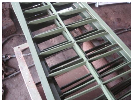
Foto 15. Bandejas del Bio-reactor con capa de pintura anticorrosiva.
