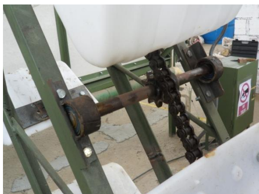
Foto 12. Guías para la cadena en la estructura de transporte por cangilones
