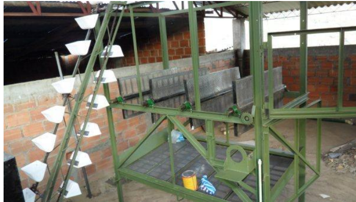
Foto 18. Bio-reactor con capa de pintura anticorrosiva.
