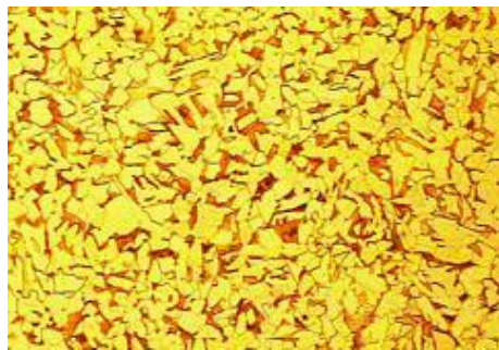
Figura 2: Microestructura de matriz ferrítica con granos de perlita equiaxial distribuidos en la matriz a 100X.
