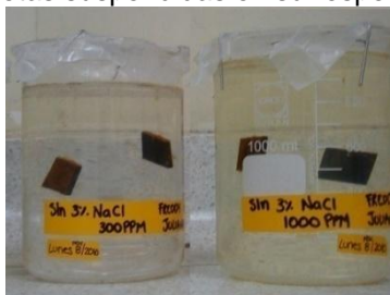
Figura 6: Probetas suspendidas en su respectivo electrolito
