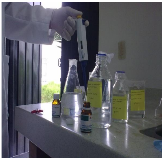
Figura 40. Procedimiento de dosificación de inhibidores
