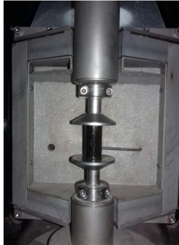
Figura 4 Esquema de porta muestras superior ajustado a la probeta para ensayo a tensión-compresión.
