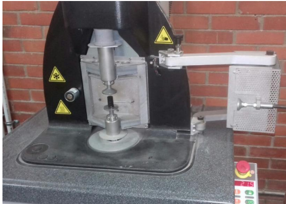
Figura 3 Montaje de una probeta en porta muestras del Analizador Dinámico Metravib.
