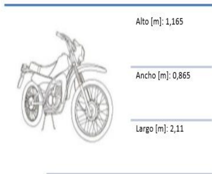
Figura 3. Dimensiones de una moto Cross (estándar).
