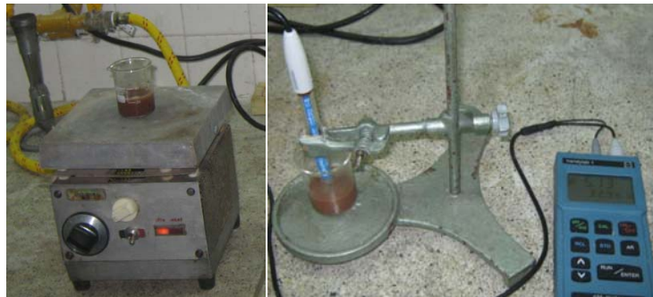
Figura 5. Montaje de determinación de pH.
