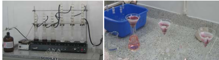
Figura 6. Montaje de determinación de grasa.
