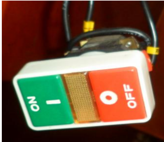
Figura 29. Dispositivo de accionamiento.
