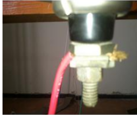
Figura 35. Conexión entre instrumento de prueba y resistencia Shunt.
