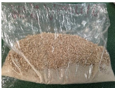
Figura 29. Muestra molida de matriz polimérica reforzada con aserrín durante proceso de desgasificación
