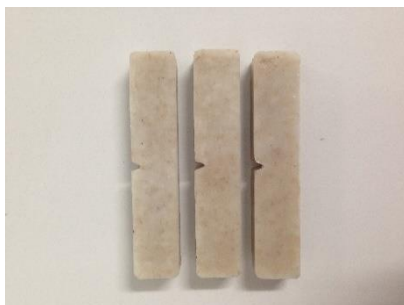
Figura 33. Probetas para pruebas de impacto
