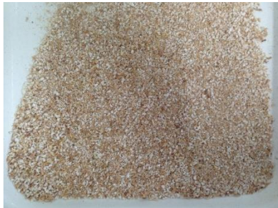
Figura 30. Muestra molida de matriz polimérica reforzada con aserrín durante el proceso de molienda
