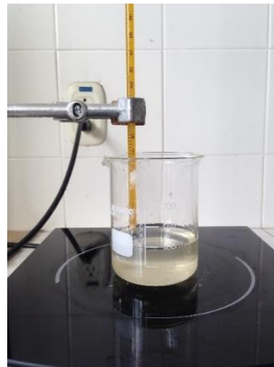
Figura 26. A) Piezas de poliestireno en medio de calentamiento. B) Piezas de poliestireno más refuerzo de aserrín en medio de calentamiento.
