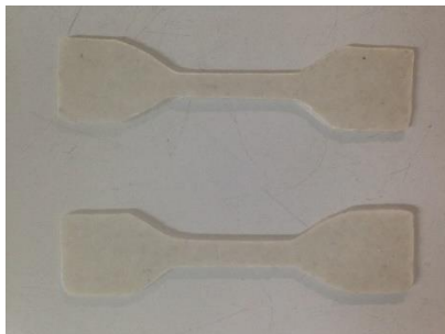
Figura 33. Probetas para pruebas de impacto
