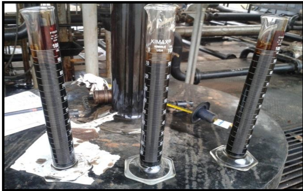
Figura 18. Pruebas aleatorias Mezcla Crudo-Gasolina-Butano
