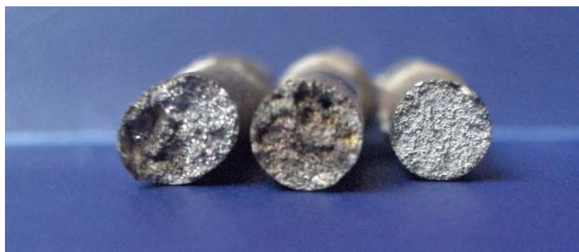
Figura 41. Fractura sección transversal de una de las probetas de tracción de las aleaciones
