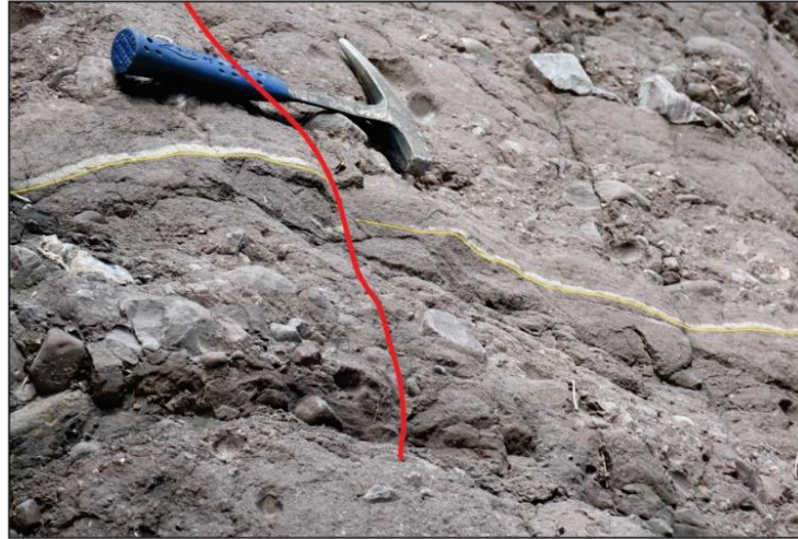
Figura 56. Falla local de cinemática normal en la sección Peña Morada. Az 290°.
