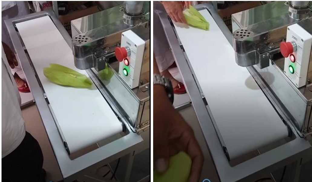
Figura 50. Prueba de funcionamiento de la banda transportadora
