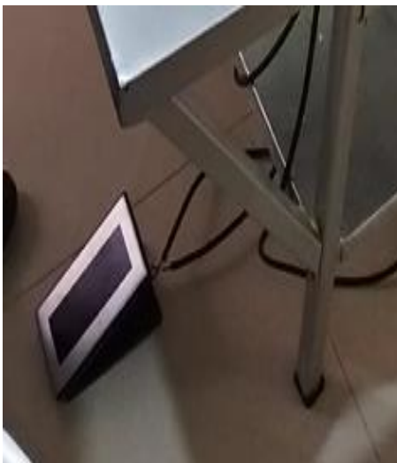
Figura 49. Pedal eléctrico para controlar los movimientos del actuador eléctrico
