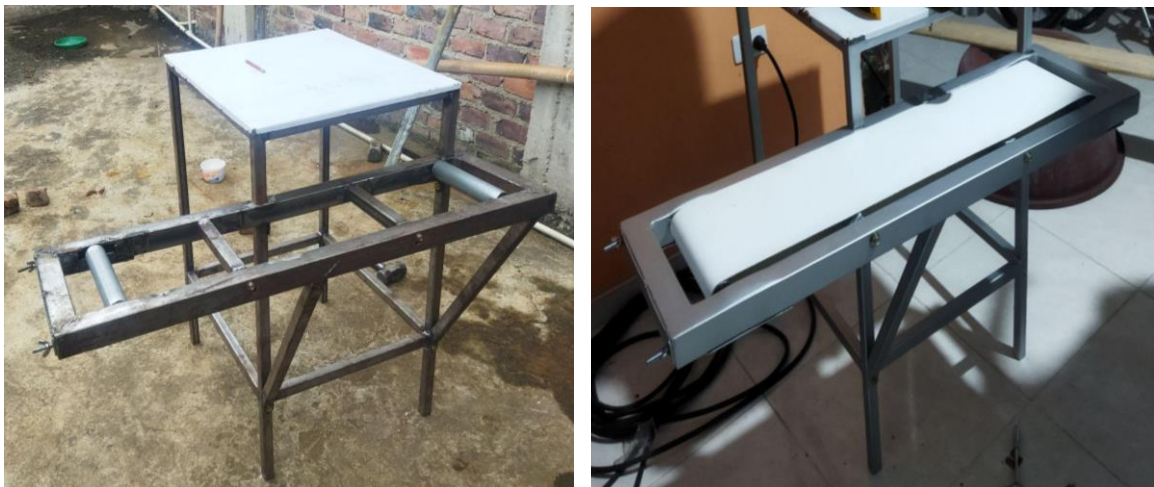
Figura 45. Construcción y montaje de la banda transportadora
