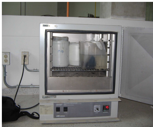
Figura 19-20. Rocas en el horno con la tempera del agua a 40°C.
