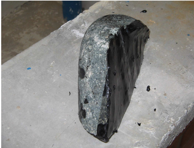
Figura 23. Rocas con grado A de adherencia: Asfalto adherido al agregado.
