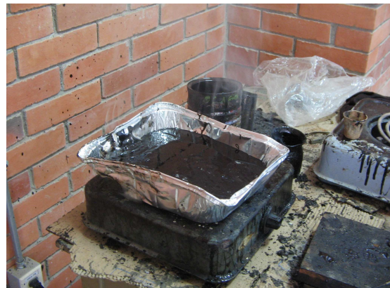
Figura 12-13. Calentamiento de las rocas y el asfalto a 150°C.
