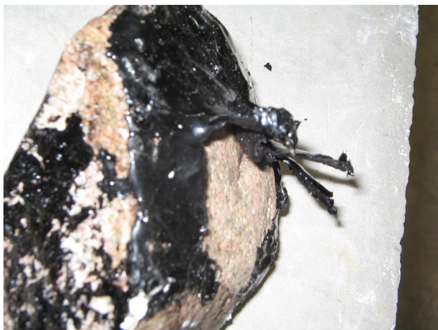
Figura 24. Rocas con grado C de adherencia: Asfalto desprendido del agregado.
