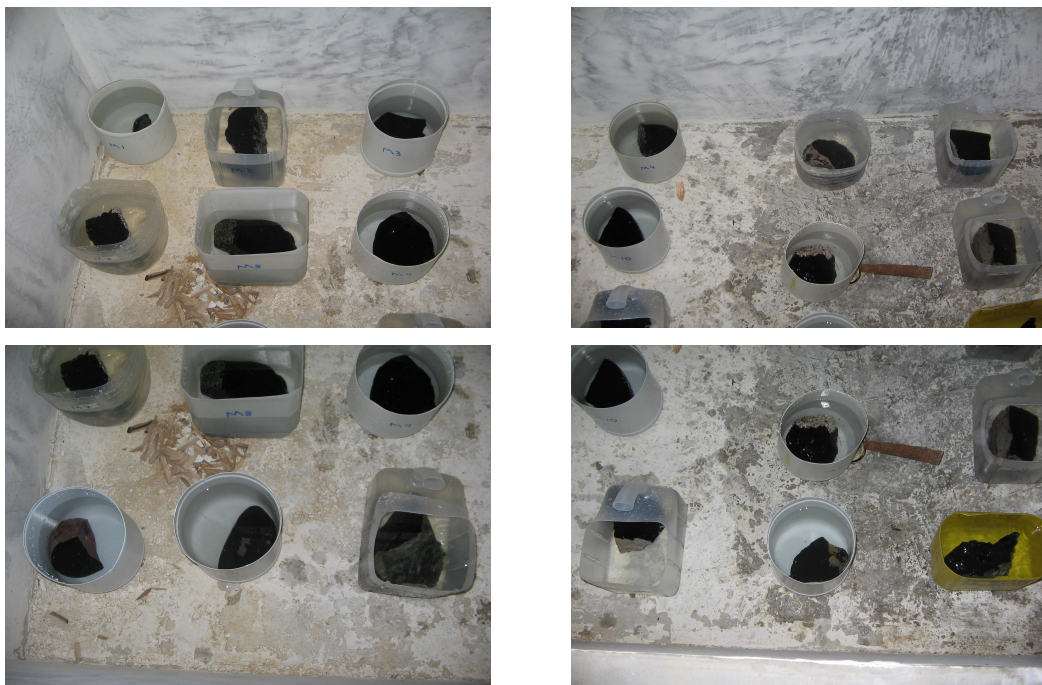
Figura 15-18. Rocas en agua a temperatura ambiente durante cuatro días.
