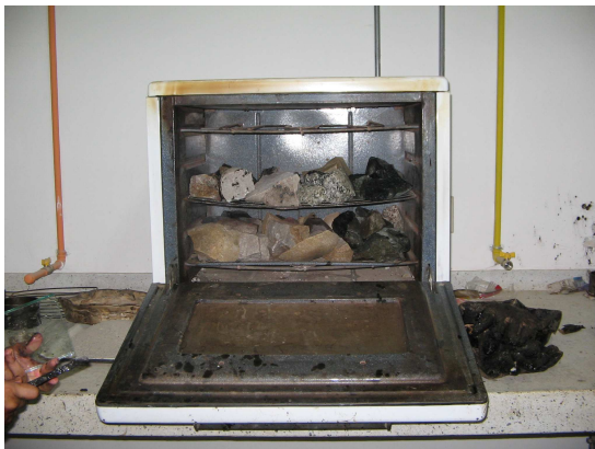
Figura 12-13. Calentamiento de las rocas y el asfalto a 150°C.
