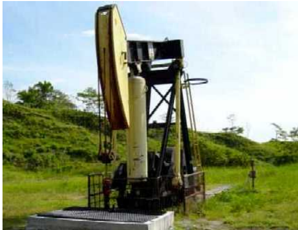
Figura 2. Unidad de Bombeo Balanceada por Aire
