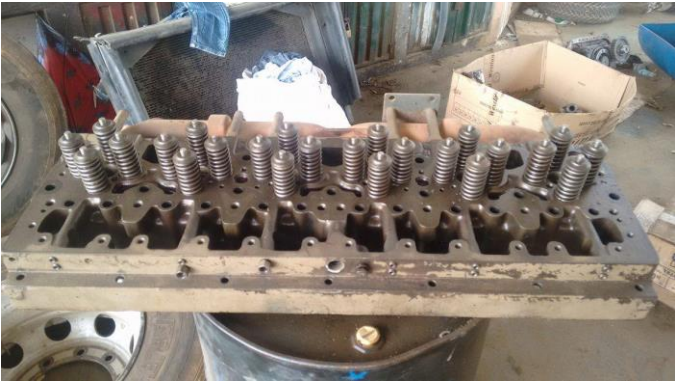
Figura 40. Válvulas de admisión y escape.
