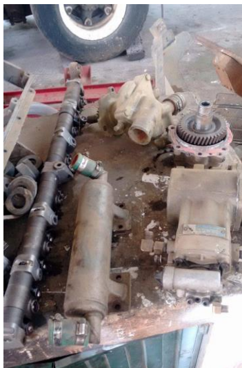
Figura 39. Árbol de levas, bomba de agua, compresor de aire.
