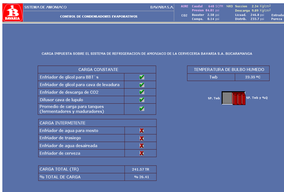
Figura 36. Visualización en el sistema SCADA de la tabla que llena el PLC automáticamente para calcular el % de carga impuesto sobre el sistema.
