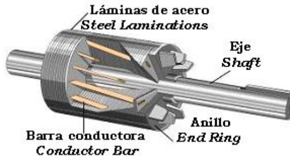
Figura 28. Montaje del rotor en un motor AC trifásico de inducción jaula de Ardilla
