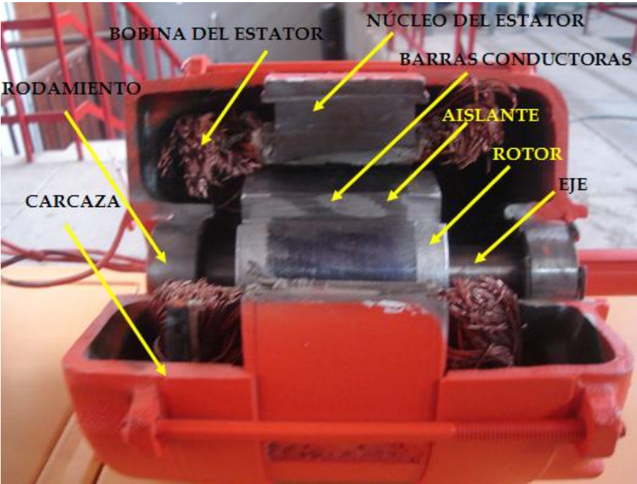
Figura 118. Motor jaula de ardilla en corte
