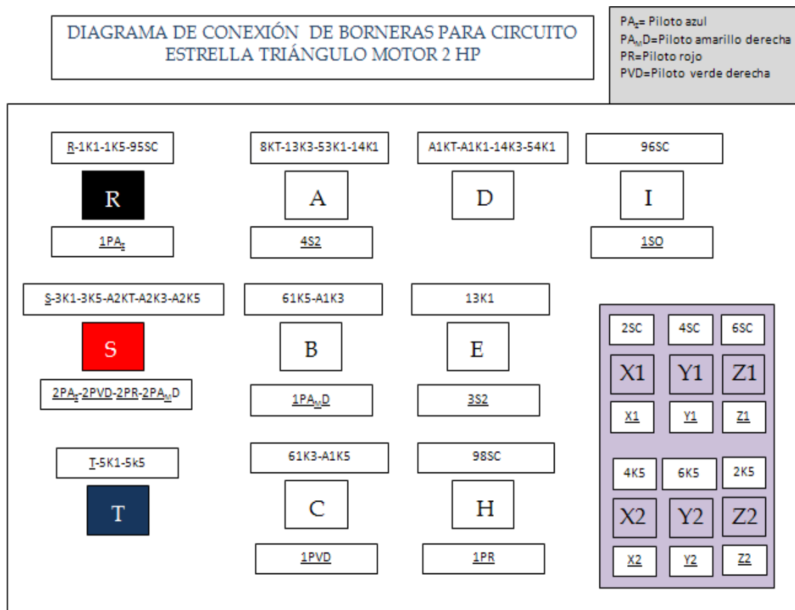
Figura 132. Diagrama de conexión de borneras estrella triángulo para motor de 2 HP trifásico
