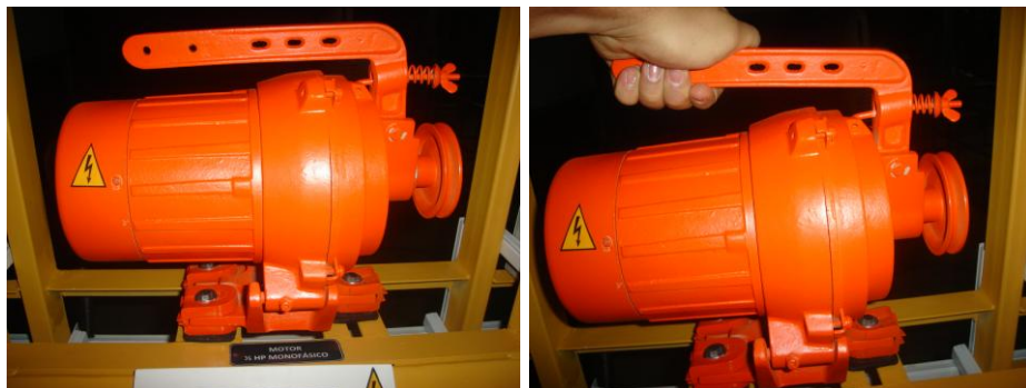
Figura 145. Dispositivo de embrague del motor monofásico de ½ HP
