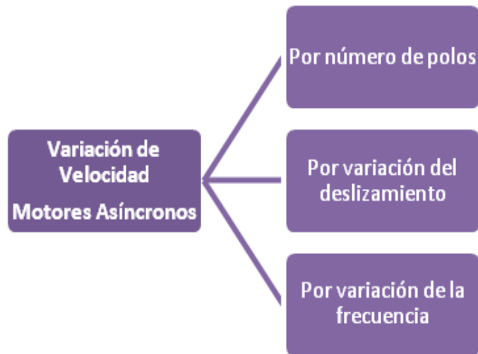
Figura 56. Formas para variar la velocidad de motores asíncronos o de inducción
