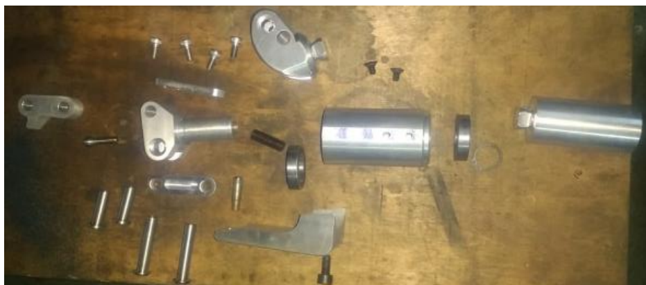
Figura 70. Explosionado de piezas fabricadas.
