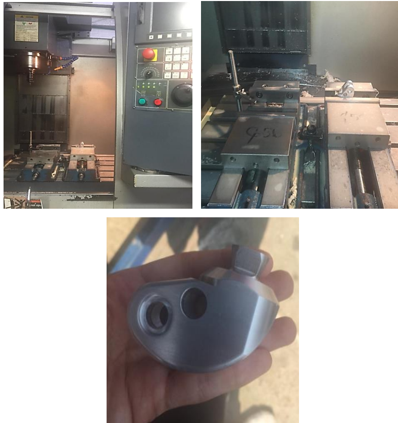
Figura 66. Centro de mecanizado CNC cuadrante acople fémur.
