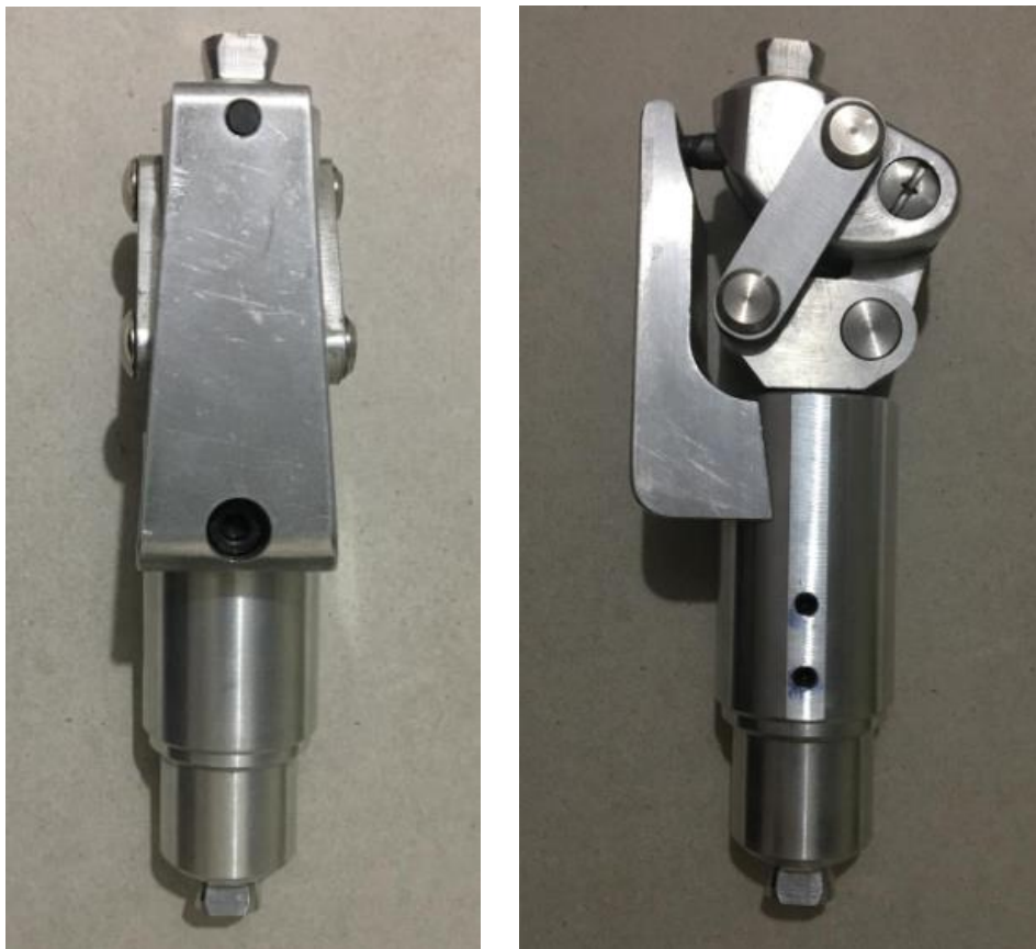
Figura 71. Ensamble del mecanismo de rodilla.
