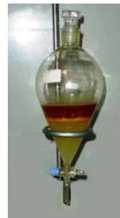
Figura 3.2 Emulsión formada por lavado mediante técnica de aspersion (fase intermedia)
