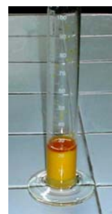
Figura 3.5 Emulsión formada en lavado con agua destilada caliente por alto porcentaje de catalizador en la reacción de transesterificación
