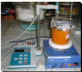
Figura 2.8 Lavado con agua destilada y solvente (agitación magnética)
