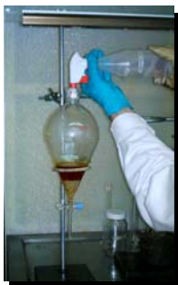
Figura 2.5 Lavado con agua destilada caliente
