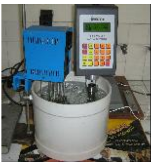
Figura 2.10 Montaje para medición de viscosidad cinemática a 40 °C
