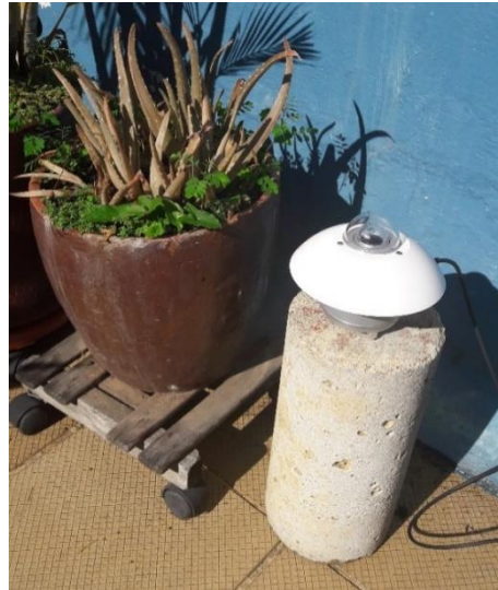
Figura 20. Prueba de medición de radiación solar con piranómetro Hukseflux
