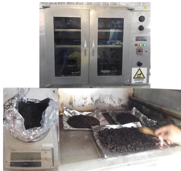
Figura 25. Proceso de secado y peso de cada uno de las muestras en los laboratorios del CENIVAM
