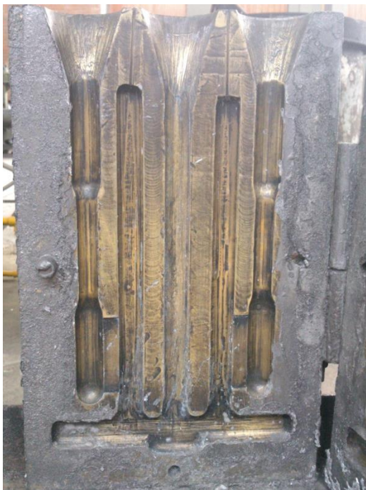
Figura 11. Coquilla y Plano de la coquilla para realizar probetas de tracción
