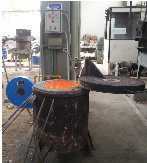
Figura 5. Horno de crisol (Escuela de Ingeniería Metalúrgica. UIS)
