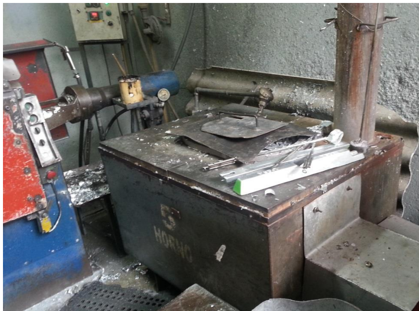
Figura 23. Horno empleado para la elaboración del prototipo
