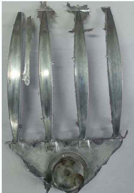
Figura 26. Prototipo recién salido del molde
