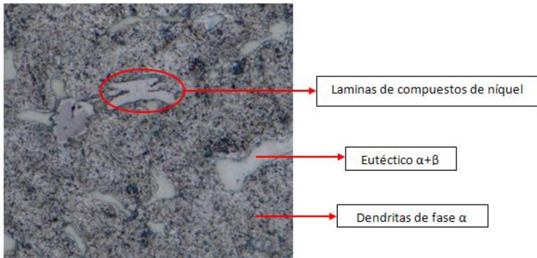
Figura 22. Micrografía de la aleación ZA16 obtenida a 200x
