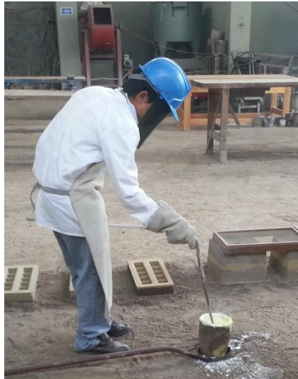
Figura 16. Medidas de temperatura luego de sacar el crisol del horno
