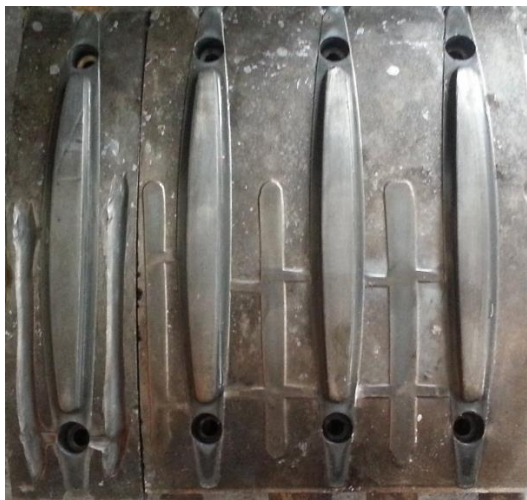
Figura 25. Coquilla empleada para elaborar manijas
