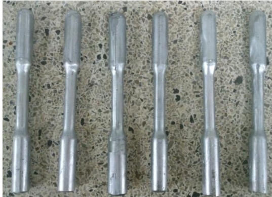
Figura 19. Probetas de ZA12 para realizar ensayo de tracción
