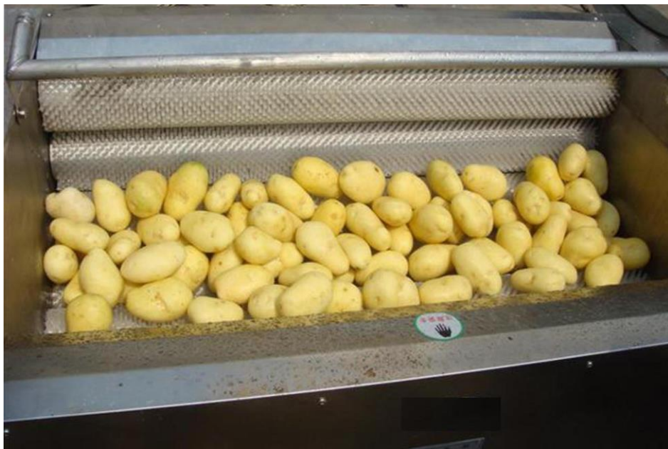
Figura 9 Peladora de papa de rodillos de cepillos.
