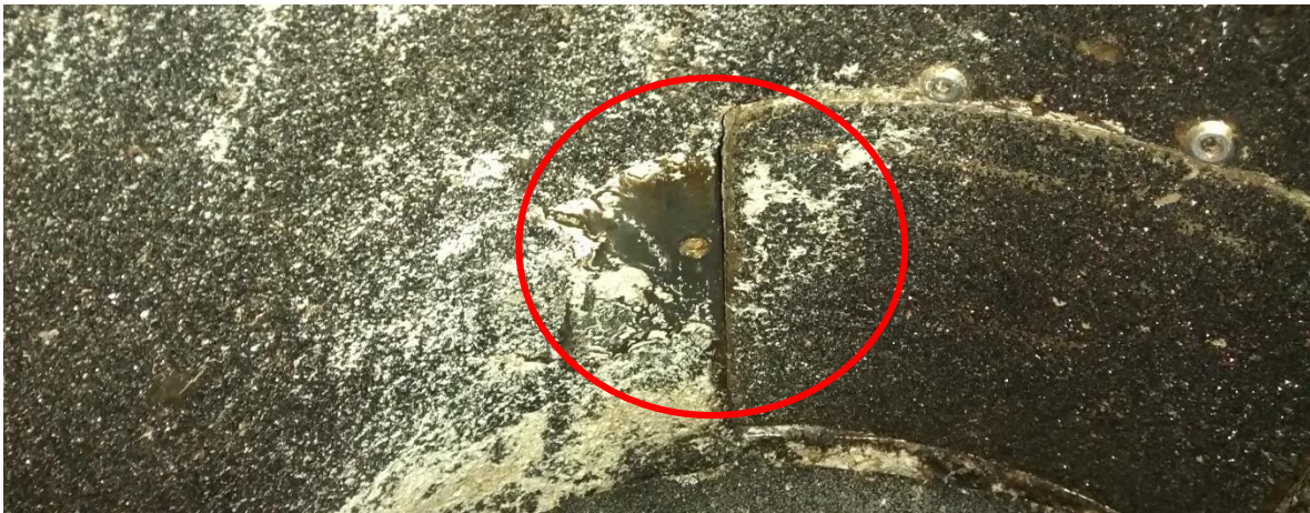
Figura 68 Pérdida de carborundo en peladora de eje vertical.
