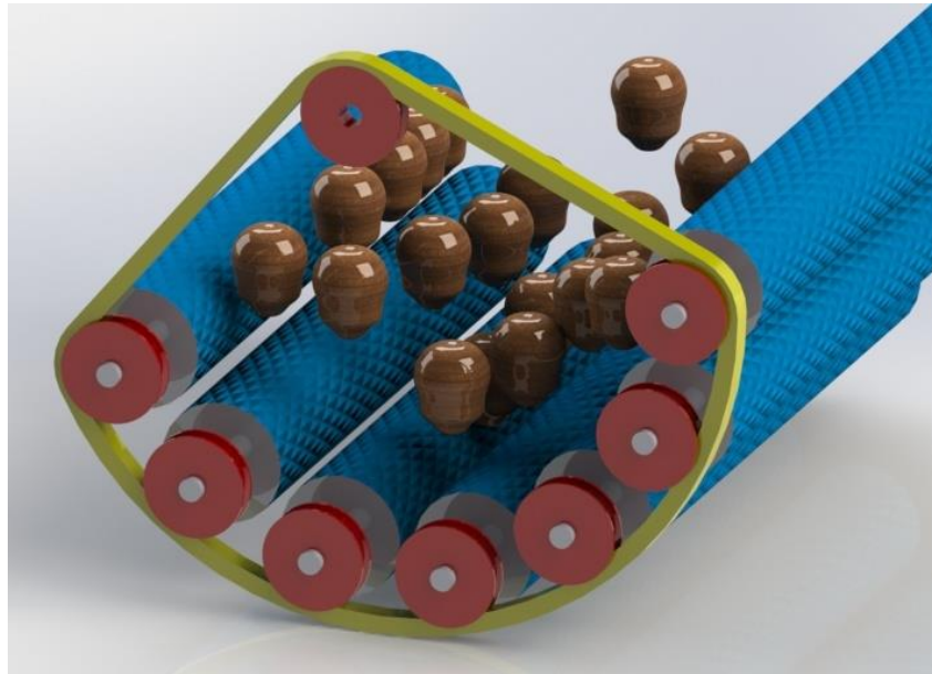
Figura 21 Una sola correa para todas las poleas.
