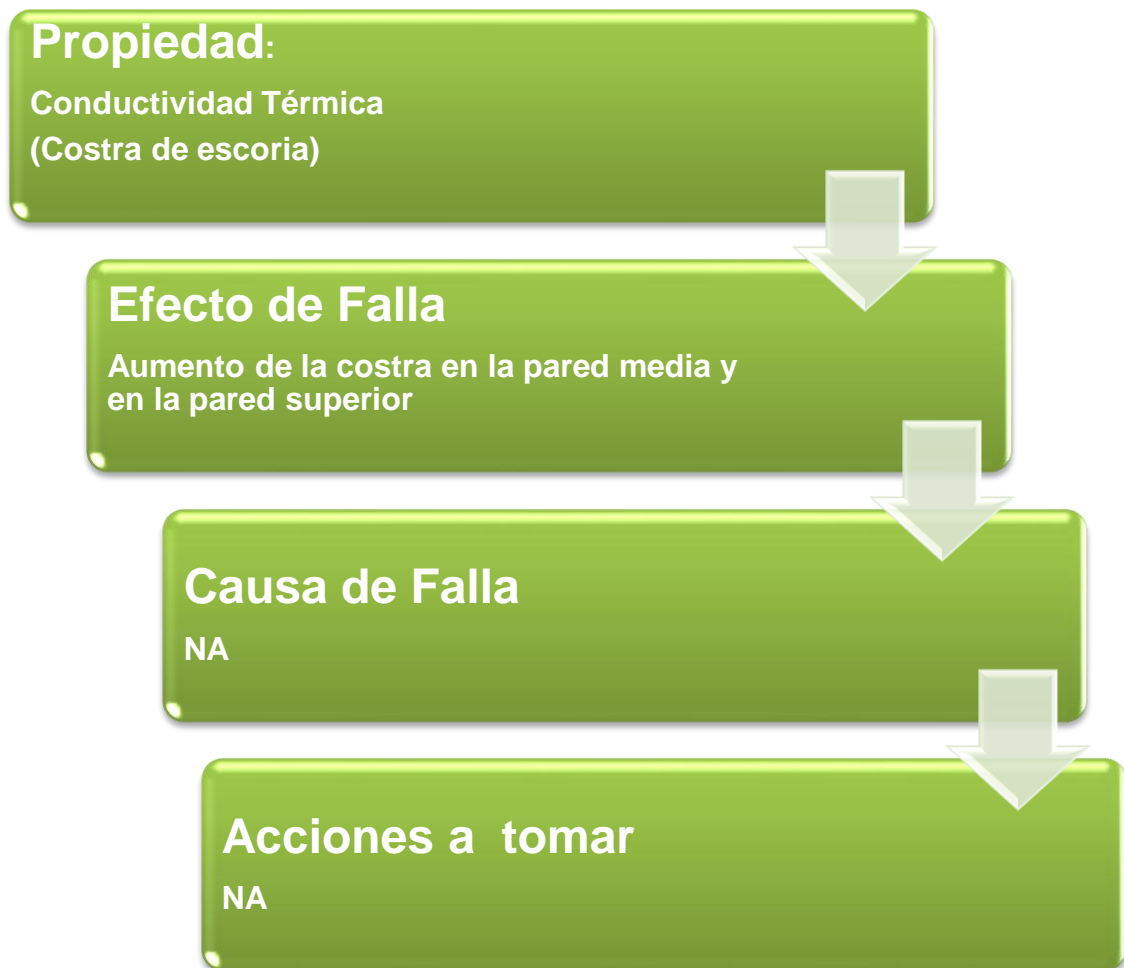
Figura 19. Carta de Navegación en función de las propiedades químicas de la escoria (Conductividad Térmica).
