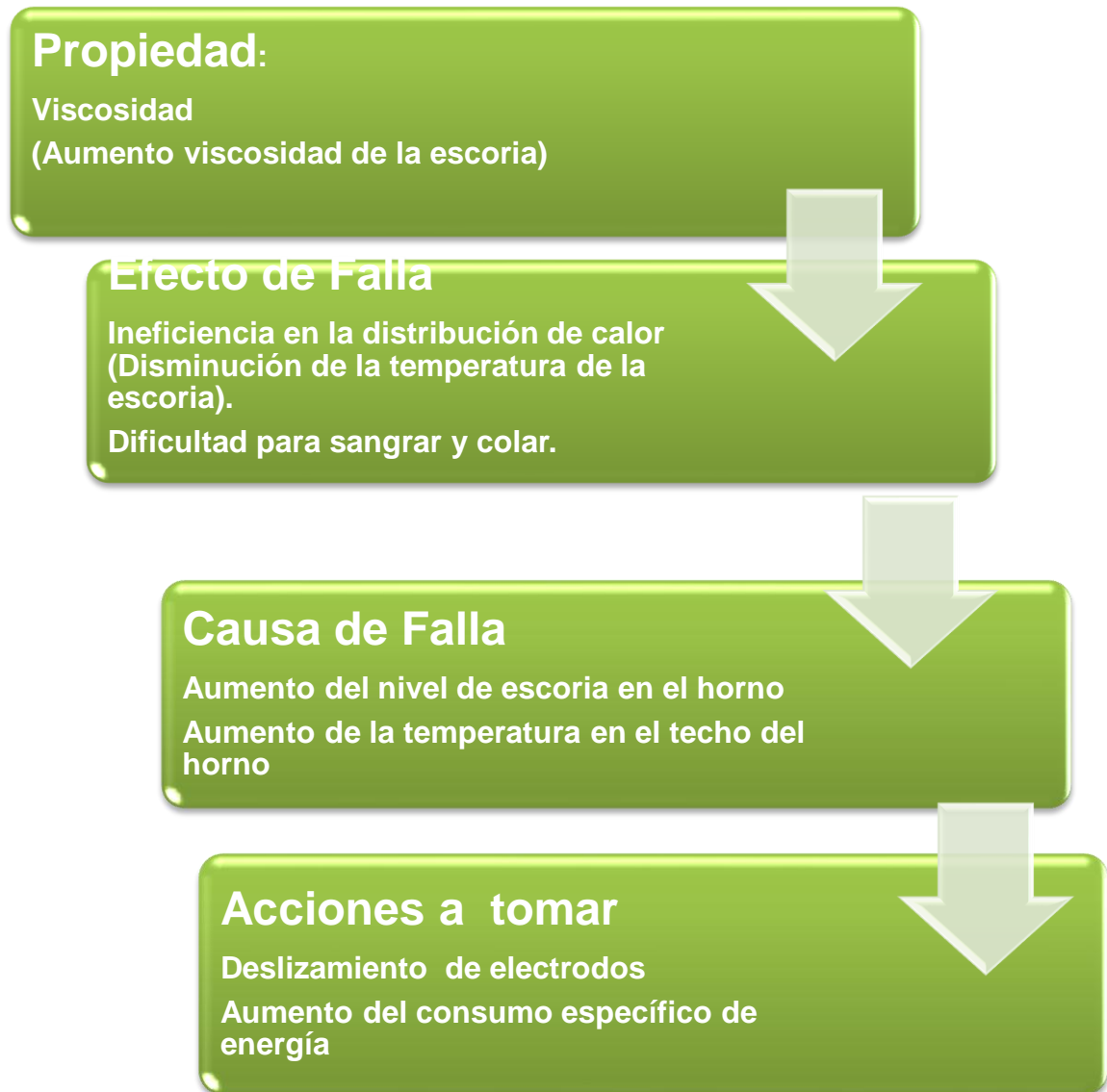
Figura 16. Carta de Navegación en función de las propiedades químicas de la escoria (Viscosidad)
