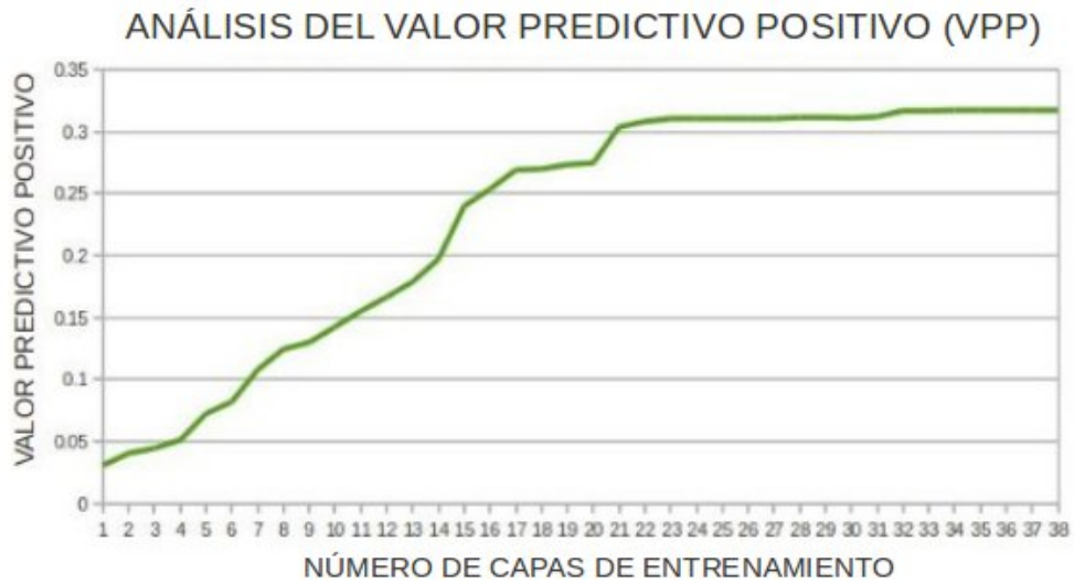
Figura 14: Análisis del Valor Predictivo Positivo VPP por capa del Detector en cascada de rostros con la base de datos CBCL FACE DETECTION #1
