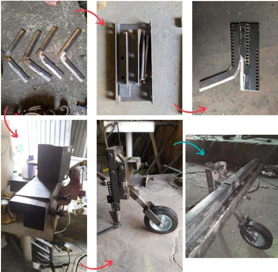
Figura 93. Construcción de los módulos de las flechas y montaje.
