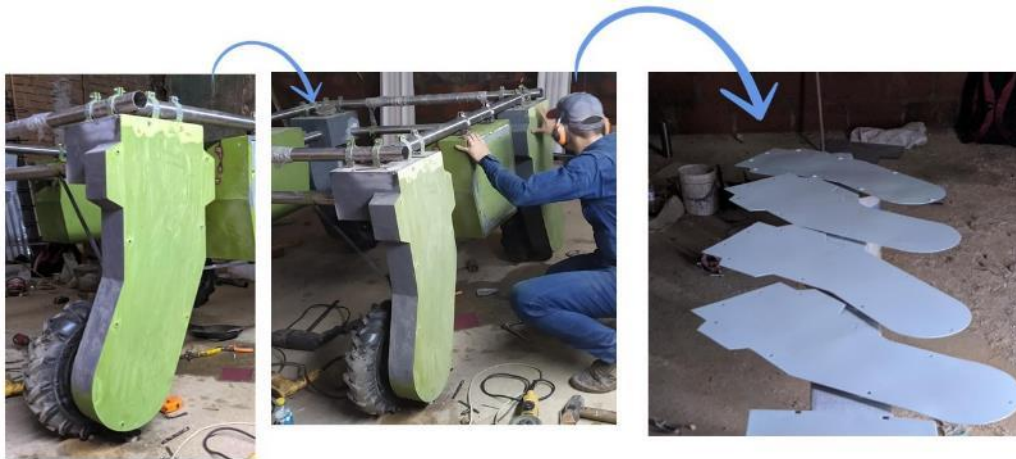
Figura 30. Fase de pintura tapa de unidad estructural de tracción.
