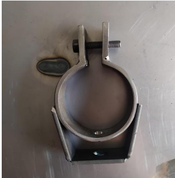
Figura 36. Componentes del soporte antes de soldadura.
