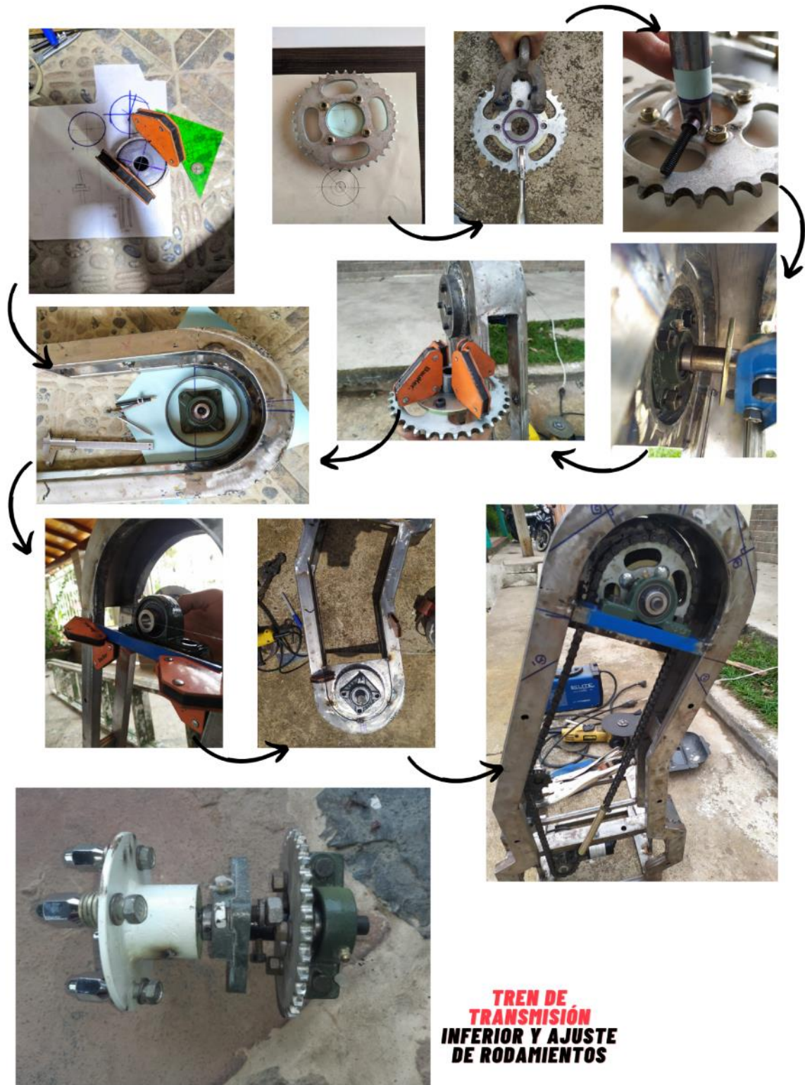
Figura 73. Proceso de ensamble del tren de transmisión inferior.
