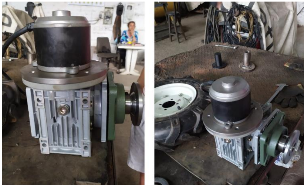
Figura 58. Adaptación de discos para los reductores de velocidad de gusano.
