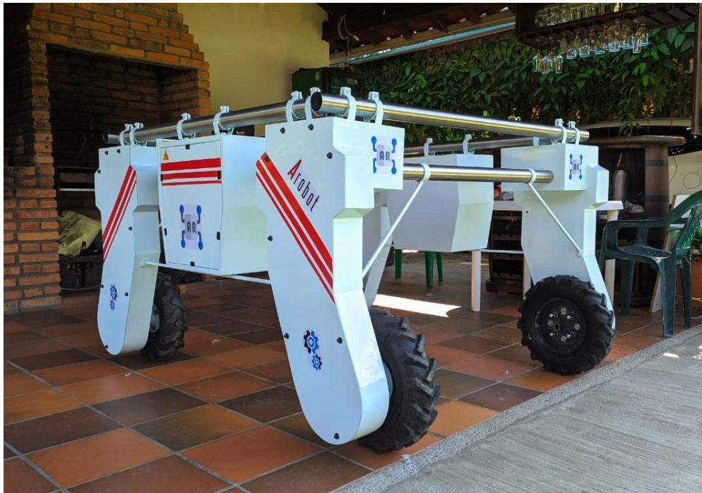
Figura 100. Prueba libre en piso de cerámica (coeficientes bajos de fricción).
