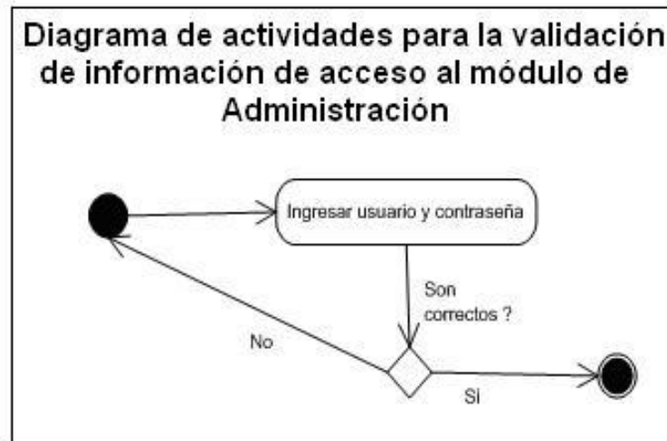
Figura 29: Diagrama de actividades para la validación de información de acceso al módulo de administración
