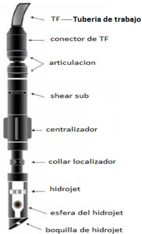
IMAGEN 22. Sarta de fracturamiento hidráulico HPAP CON PROPPANT PLUG DIVERSION (PPD) CON TAPON DE ARENA.
