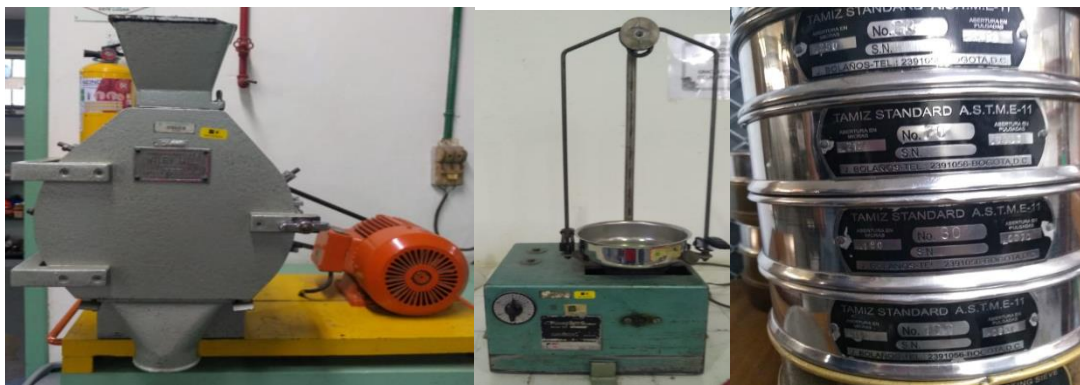
Figura 4. Equipos utilizados en la preparación de la biomasa a) Molino de martillos b) Tamizadora eléctrica c) Tamiz número 100.
