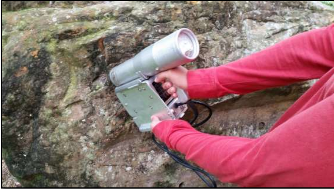
Figura19. Modo de empleo del scintillometer durante la toma de datos.
