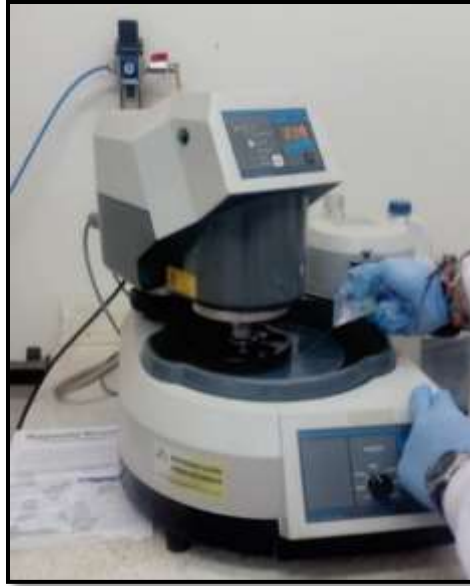
Figura 16. Devastadora y Pulidora utilizada en la preparación de secciones pulidas.
