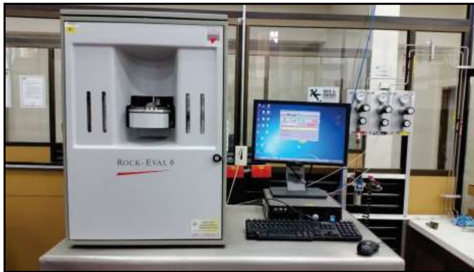
Figura 14. Pirolizador anhídrido marca Rock-Eval 6 Turbo utilizado en la determinación los parámetros S1, S2, S3 y T máx .
