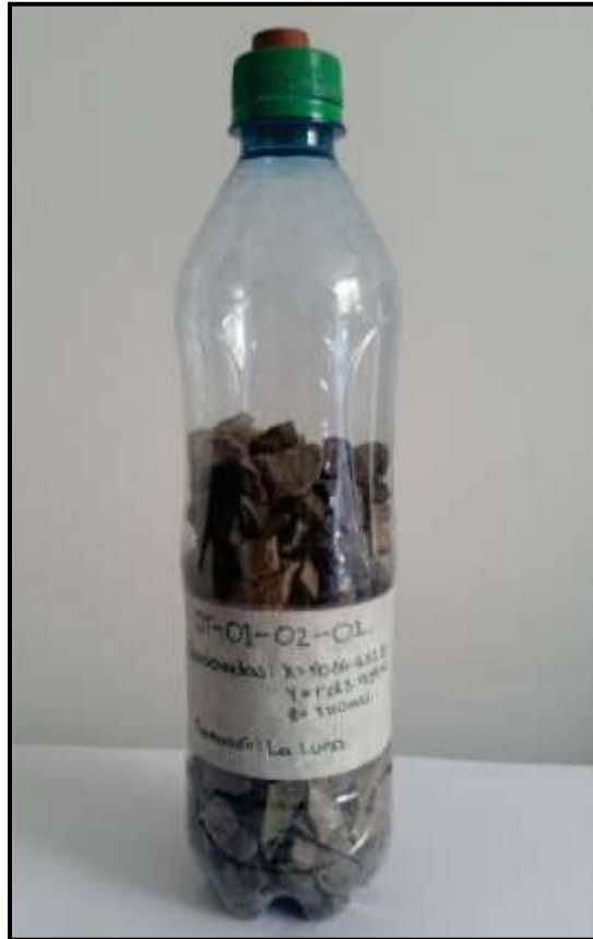
Figura 9. Muestras de roca fresca depositadas en botellas y tapadas con un sello hermético que impida la fuga de gas.
