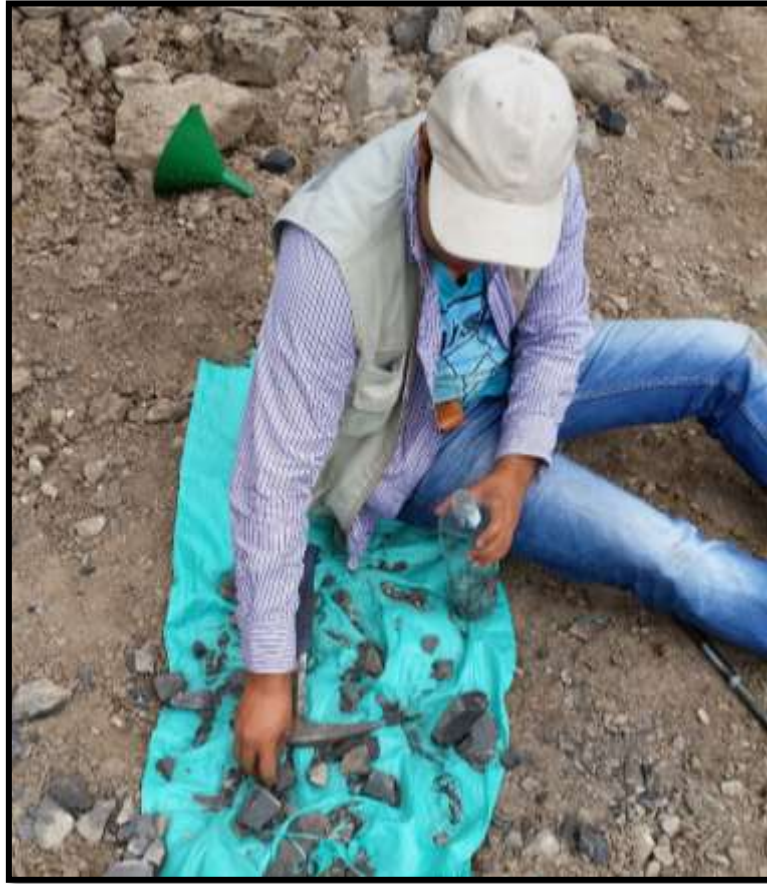
Figura 8. Fracturamiento y recolección de muestra en recipiente de polietileno.
