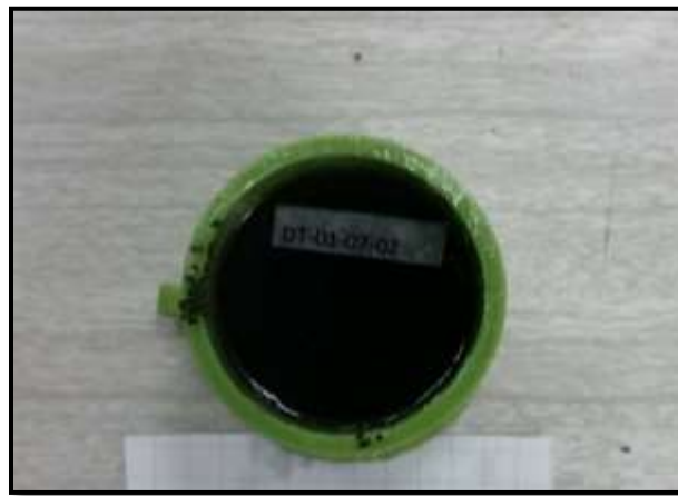
Figura 15. Muestra Granulada con resina en el molde de plástico.
