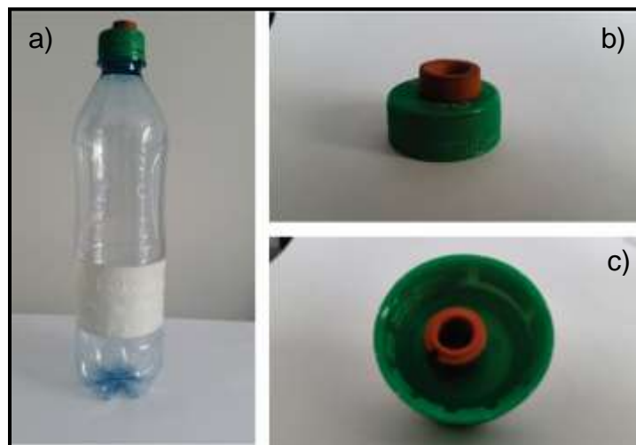
Figura 10. Técnica de espacio Libre, a) Prototipo de botella. b) Tapa con sello hermético. c)
