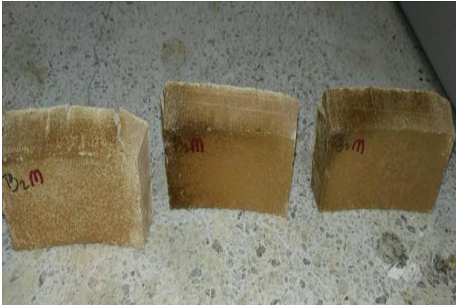
Figura 12. Evidencia de daños, cara posterior del ladrillo
