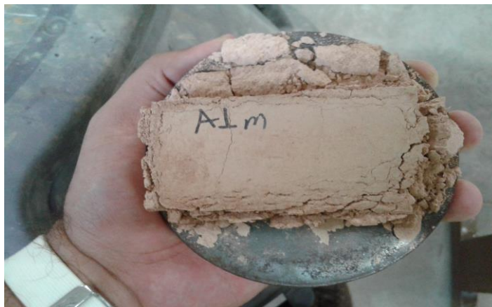
Figura 4. Evidencia de falla luego del ensayo de compresión
