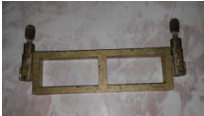
Figura 2. Molde empleado en la fabricación del ladrillo ecológico
