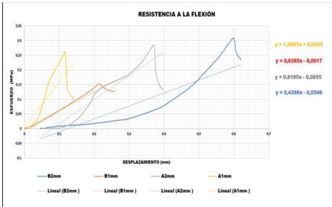
Figura 9. Resistencia a la flexión muestras expuestas a la temperatura de tratamiento al calor mínima 80 (°C)
