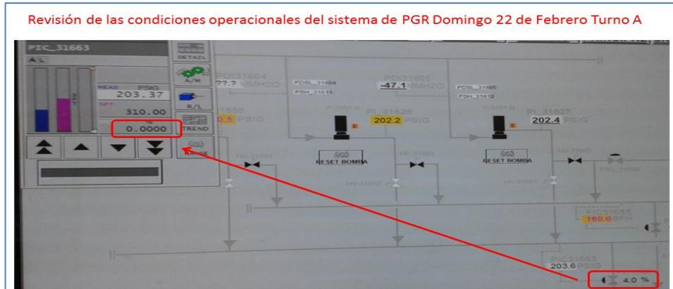
**Figura 35.** Comparación apertura válvula y presión alcanzada
