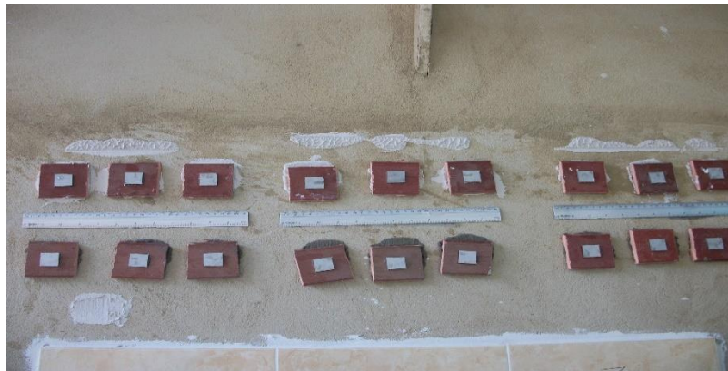
Figura E 3. Deslizamiento en superficies verticales cerámica-concreto utilizando pegantes de PEGAMASTER Y SIKA COLOMBIA.
