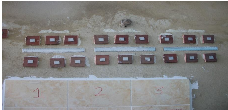
Figura E 2. Deslizamiento en superficies verticales cerámica-concreto utilizando pegantes de PEGAFORD.
