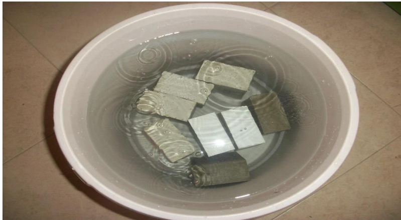
Figura E 1. Prueba de absorción de agua utilizando los pegantes de PEGAMASTER Y SIKA COLOMBIA.
