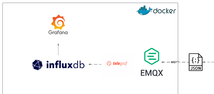
Figura 12 NETIG STACK Arquitectura NETIG para la capa de datos de Smart Campus UIS.
