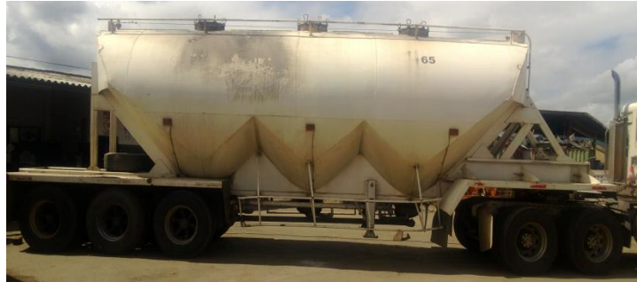
Figura 47. Tolva de cemento
