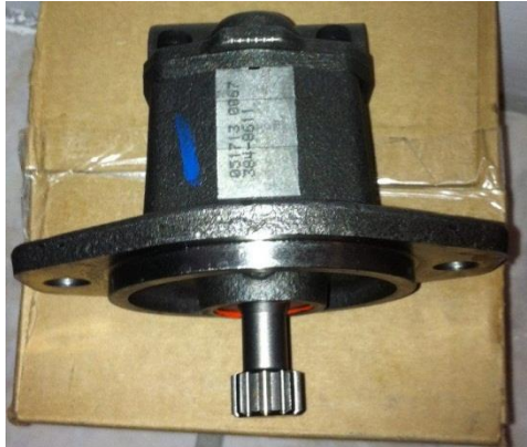
Figura 20. Bomba de Transferencia
