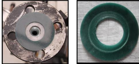
Ilustración 12 Sello hidráulico plano RF, material: PU-CO:GP(40:60) antes y después de la prueba hidrostática.
