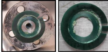
Ilustración 14 Sello hidráulico plano RF, material: PU-CO:GP(40:60)) antes y después de la prueba hidrostática
