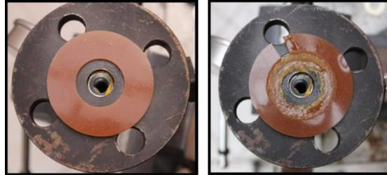
Ilustración 15. Sello hidráulico plano RF, material: PU-CO:GP(70:30) antes y después de la prueba hidrostática) a 38°C ± 3°C, 12 h de prueba.
