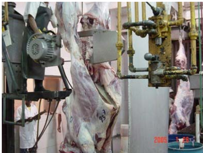
Figura 11. Faenado: el operario de la sierra está ubicado en un elevador para realizar el corte
