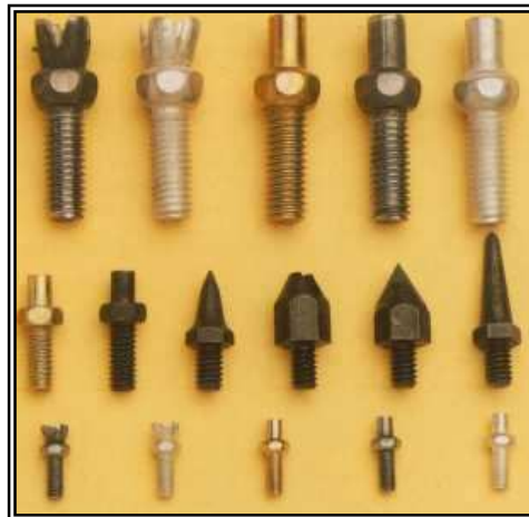
Figura 8. Tipos de espárragos adaptables a los marranos para diferentes grados de limpieza
