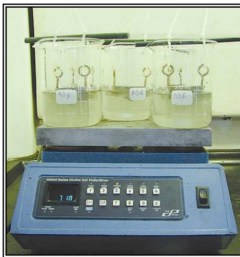
Fotografía 10. Montaje para el lavado químico (plancha de calentamiento con 5 puntos de agitación – ICP.
