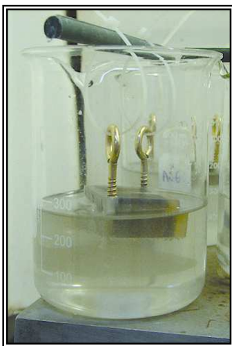
Fotografía 10. Montaje para el lavado químico (plancha de calentamiento con 5 puntos de agitación – ICP.
