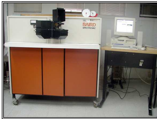
Fotografía 11. Espectrómetro de emisión óptica, Spectrovac 1000 DVR. Laboratorio de Resistencia de Materiales ICP
