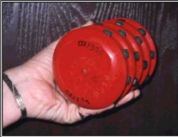
Figura 6. Marrano para limpieza en tubos de Hornos
