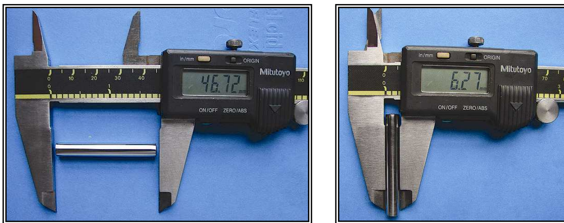
Fotografía 15. Dimensiones del electrodo de acero ferrítico ASTM A – 335 Gr P91.
