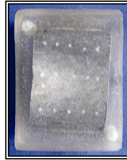
Fotografía 6. Probeta en acrílico pulida
