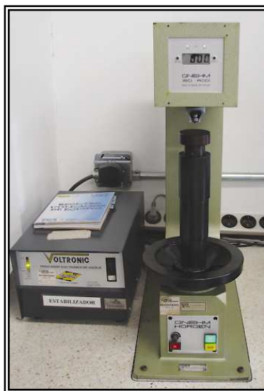
Fotografía 8. Durómetro GNEHM 160RODI, Escala Rockwell. Laboratorio de Resistencia de Materiales ICP
