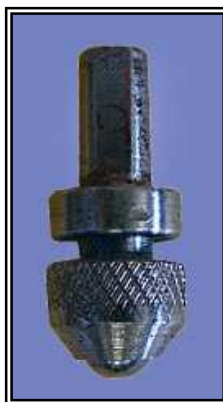
Fotografía 9. Indentador bola de acero de \frac{1}{4} “ Escala Rockwell 15X (HR15X)
