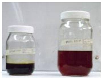
Figura 3.4- Productos de la transesterificación con álcali; glicerina (izq.), metil éster (der.).
