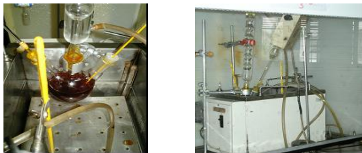
Figura 2.6- Proceso de transesterificación.
