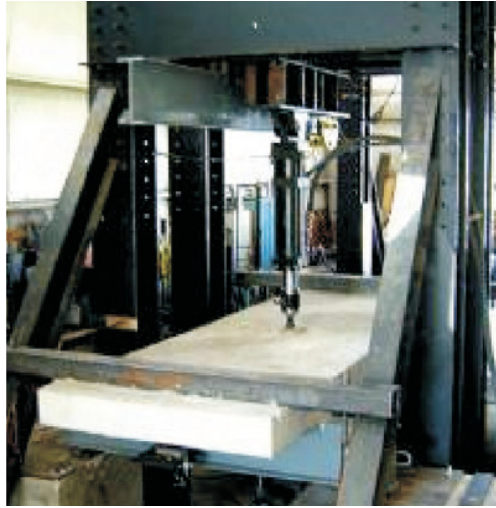
Figura 3.15 Ensayo dinámico en la losas
