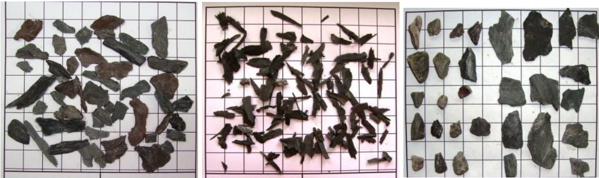
Ilustración 69. Cavings generados en la pared del hueco durante la perforación
