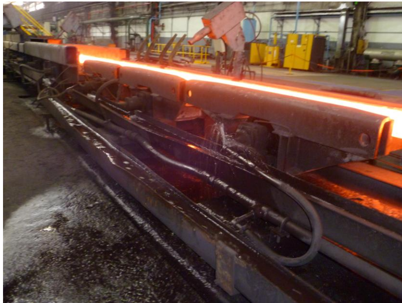
Figura 1. Refrigeración camino de rodillos Tren Morgan
