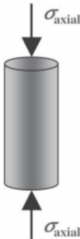
Figura 11. Esquema de la prueba de compresión uniaxial.
