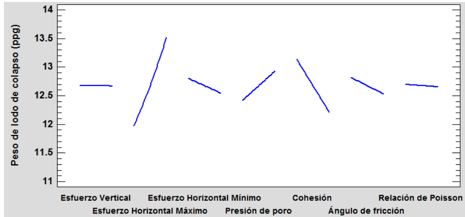
Figura 34. Diagrama de efectos principales para el peso de lodo de colapso.
